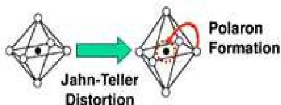
Figure I-10: Formation du polaron Jahn -Teller suite à la déformation de l'octaèdre MnO_6 de l'ion Mn^{3+} .
