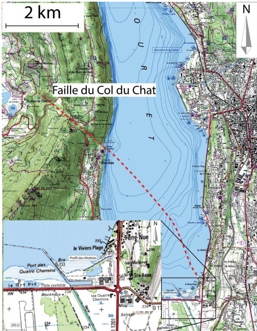
Figure IV-28 : Carte du profil électrique réalisé en février 2014. Le fond de carte provient du Scan 25® de l'IGN.
