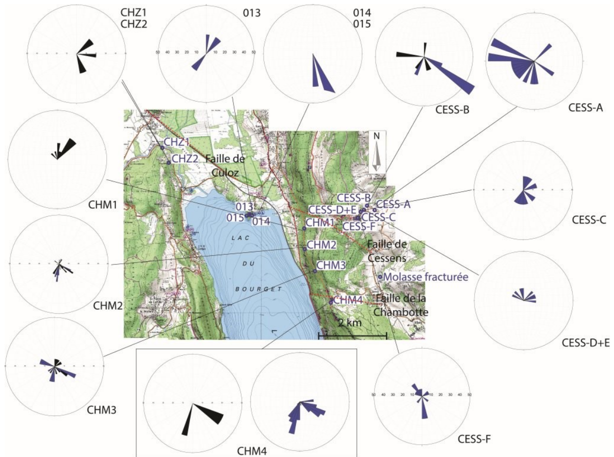
Figure IV-4 : Diagramme en rose montrant la fréquence des orientations de la direction de l'horizontale des mesures réalisées au Nord du lac du Bourget ainsi que leur localisation. En noir, les failles, en bleu les fractures. Deux diagrammes sont présentés pour CHM4 pour plus de lisibilité. Le fond de carte provient du Scan 25® de l'IGN.
