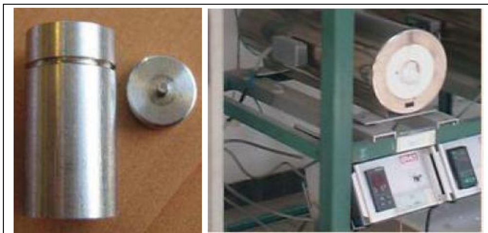
Figure II. 2: a) Creuset en acier inoxydable utilisée pour la préparation du \text{MgNi}_2 par frittage, b) Four tubulaire à résistance.
