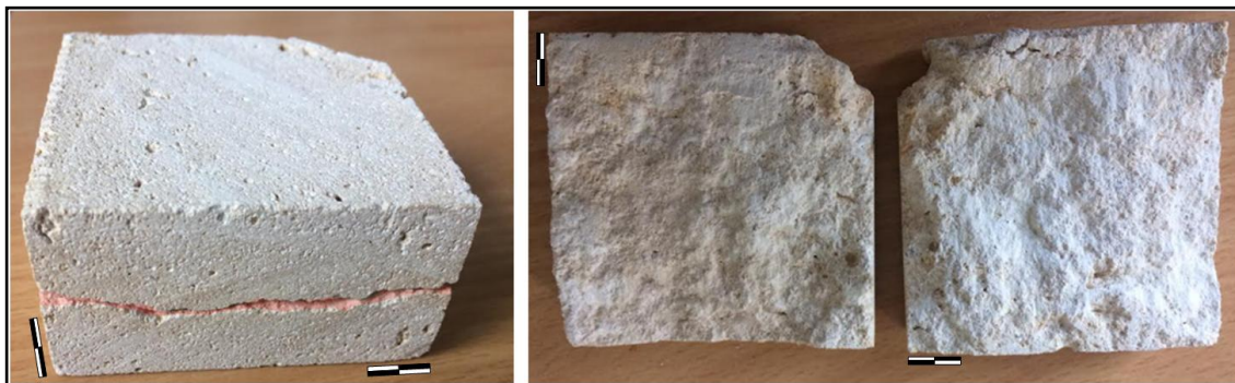
Figure 3-33 Joint naturel non lisse après cisaillement
