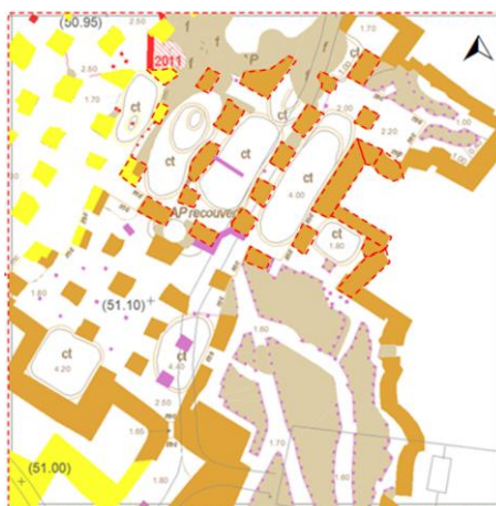
Figure 4-30 Zone des trois fontis elliptiques (carte souterraine de la Brasserie (IGC) voir la figure 3-1)
