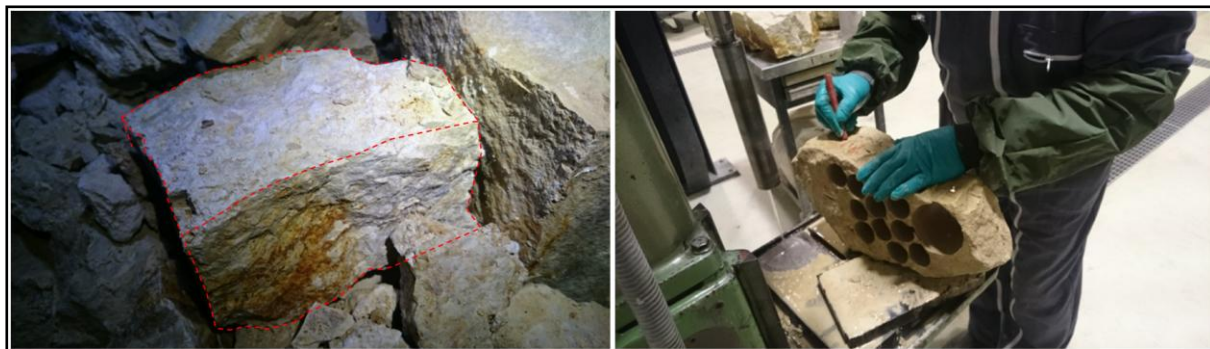
Figure 3-5 Exemple d'un échantillon de bloc prélevé dans la carrière (à gauche) pour réaliser des éprouvettes (à droite)
