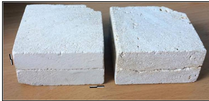
Figure 3-30 Joint lisse (à gauche), joint non lisse (à droite) (l'échelle vaut 1 cm)
