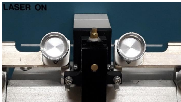
Figure 156 Zoom sur les mâchoires et le capillaire qui est centré dans la zone d'irradiation laser.
