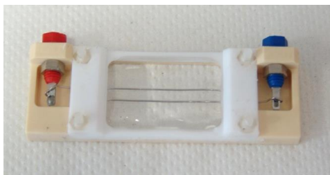
Figure 154 Chambre d'électroformation fils de Pt. Distance entre les fils = 3 mm.
