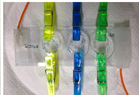
Figure 153 Chambre d'électroformation lames ITO avec espaceur PDMS 3 mm.
