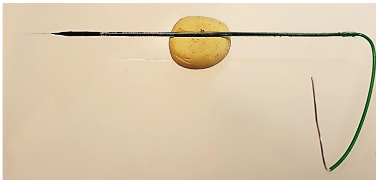
Figure 160 Ultramicroelectrode fibre de carbone dont la connexion entre la fibre et le fil est faite avec de la poudre de carbone.
