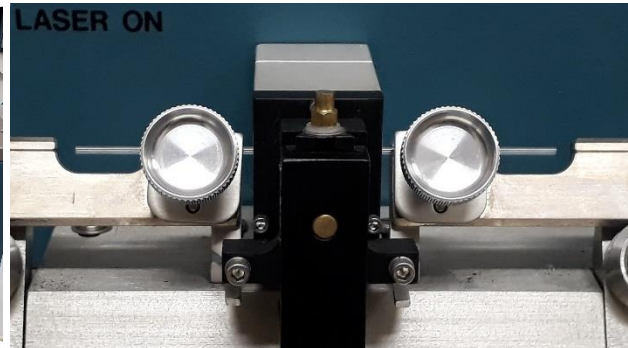
Figure 156 Zoom sur les mâchoires et le capillaire qui est centré dans la zone d'irradiation laser.
