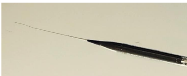
Figure 161 Zoom sur la pointe du capillaire mettant en évidence la fibre de carbone qui dépasse. La pointe en verre est étirée de façon à sceller l'électrode.
