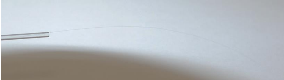
Figure 158 Fibre de carbone (10 \mu\text{m} de diamètre) insérée dans un capillaire en verre (diamètre externe = 1 mm).
