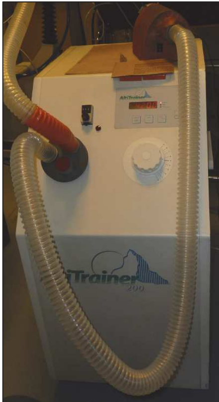
Figure 45 : photo de l'Altitrainer ® utilisé pour créer un environnement hypoxique.
