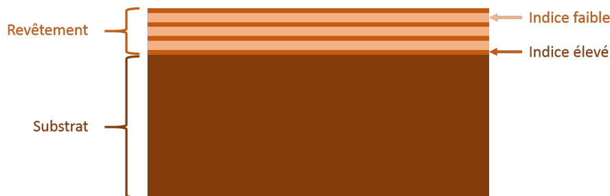
Figure 3.9: Représentation schématique d'un miroir avec son substrat et son revêtement. Le revêtement est composé d'une alternance de couches de différentes épaisseurs et différents indices de réfraction.
