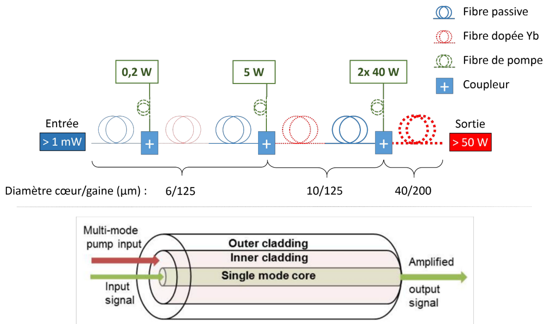
Figure A.6: Haut : schéma simplifié de l'amplificateur fibré. Se lit de gauche à droite. Bas : fonctionnement d'une fibre dopée.
