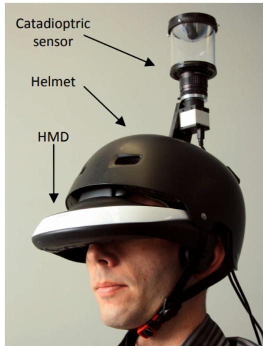
FIGURE 2.2 – Le casque de réalité augmentée FlyVIZ [Ardouin et al. , 2012].
