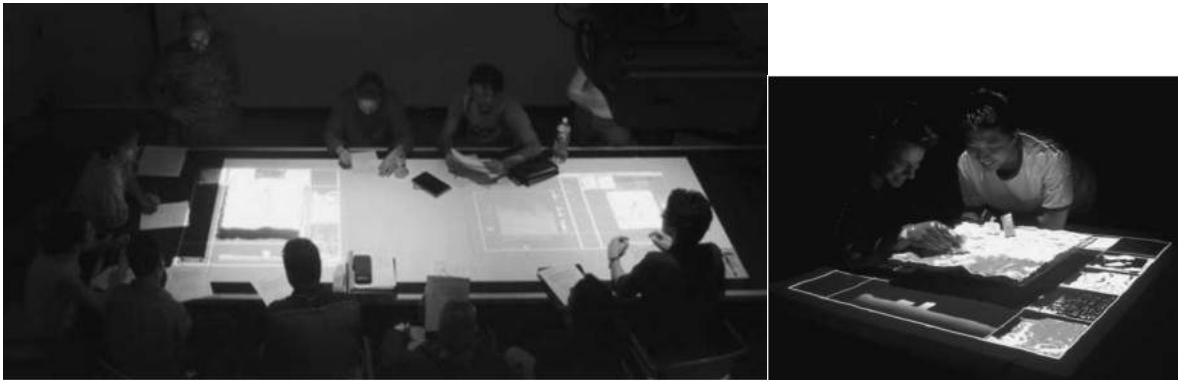
FIGURE 1.10 – Illustrations de l'environnement proposé par Illuminating Clay, où des acteurs de métiers différents, à gauche, collaborent autour d'une interface en relief sur lequel une projection est réalisée dynamiquement, à droite (issues de (RATTI et al., 2004)).
