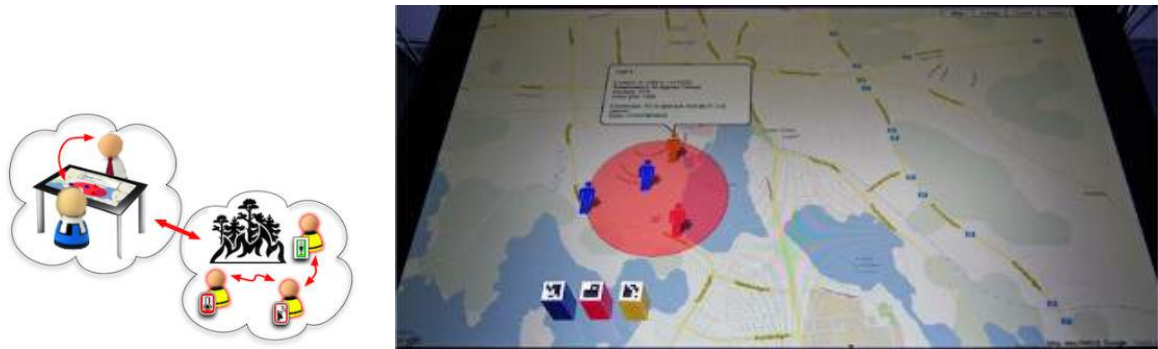
FIGURE 1.4 – Illustration tirée de (CERNEA et al., 2012) illustrant la mise en place d'un système combinant l'utilisation d'une table tangible avec un dispositif portable de type brassard pour les acteurs sur le terrain (à gauche de l'image). Une partie de la visualisation (à droite de l'image) et de l'envoi d'informations est prise en charge automatiquement par le système.
