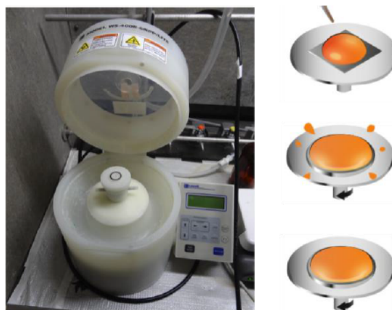
Figure 27: Spin-coater: illustration de la procédure de dépôt.
