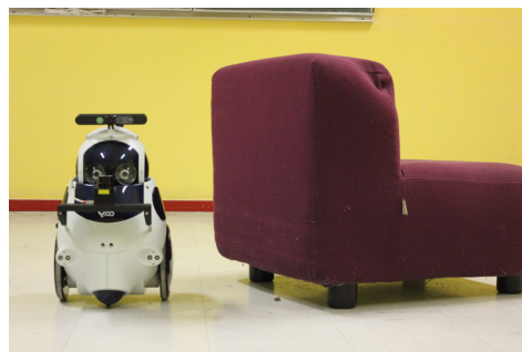
FIGURE 4.28 – Le robot Q.bo à côté d'un fauteuil bas : si le robot est proche du fauteuil, celui-ci obstruera entièrement sa perception visuelle
