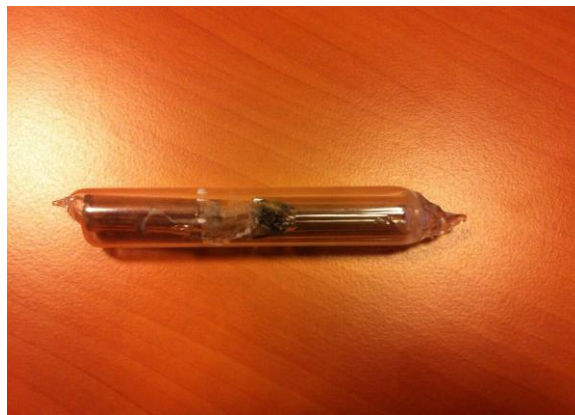
Figure III. 41 : Image d'un échantillon soluble mis entre deux intercalaires dans une ampoule scellée.
