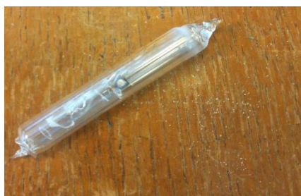
Figure II. 1 : Tube de Silice scellé en quartz contenant l'échantillon pour recuit.
