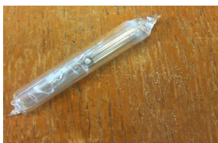
Figure II. 1 : Tube de Silice scellé en quartz contenant l'échantillon pour recuit.
