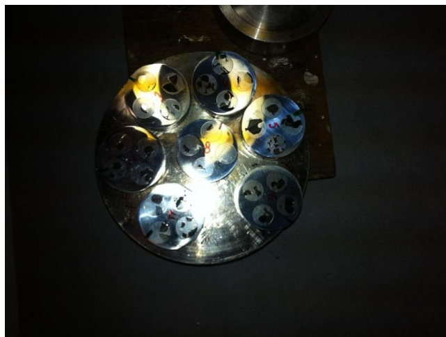
Figure II. 6 : Échantillons disposés dans des porte-échantillons métalliques pour l'analyse MEB
