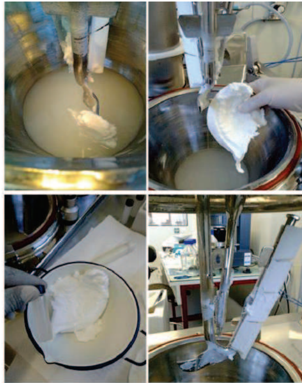
Figure 83: Vidange du Becomix après synthèse des nanoparticules encapsulant de l'Insuman®
