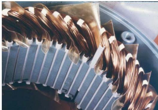
Figure I.10 : Photographie mettant en évidence l'isolation entre phases (têtes de bobines) d'un bobinage distribué triphasé [12]
