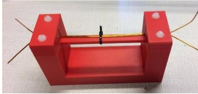
Figure IV.1 : Dispositif utilisé pour la détermination expérimentale de la TADP – Validation du modèle de deux fils parallèle
