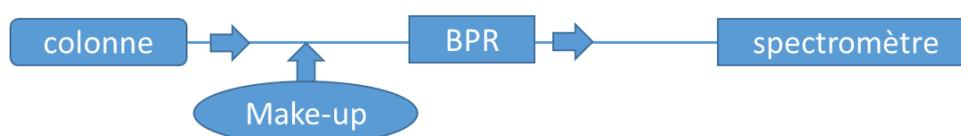
Figure 122 : Représentation schématique du couplage initial.
