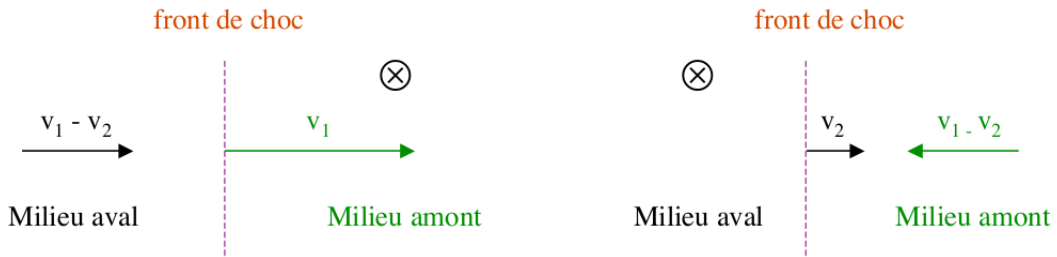
FIGURE 1.5 – Schéma illustrant le passage de l'onde de choc depuis le référentiel du milieu aval et depuis le référentiel du milieu amont. Dans les deux cas, l'autre milieu apparaît comme se déplaçant avec une vitesse \Delta v = v_1 - v_2 . Figure issue de [19].
