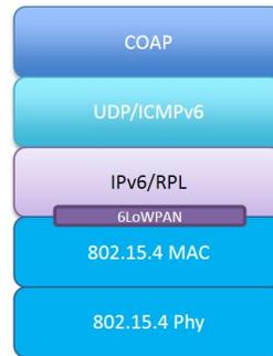
FIGURE 3.9 – Modèle OSI du standard 6LoWPAN.
