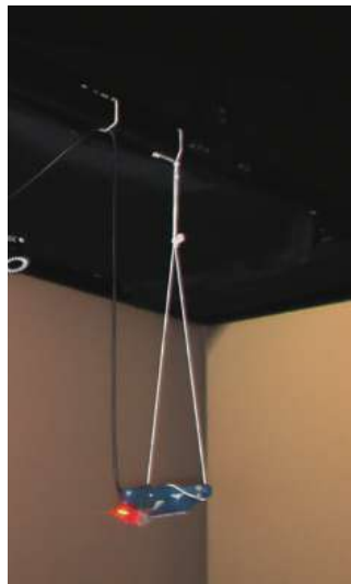
FIGURE 2.10 – Pendule utilisé par Steed pour mesurer la latence [133]. Grâce à La LED rouge accrochée au pendule, les auteurs extraient facilement la trajectoire du pendule sur les images prises par une caméra.
