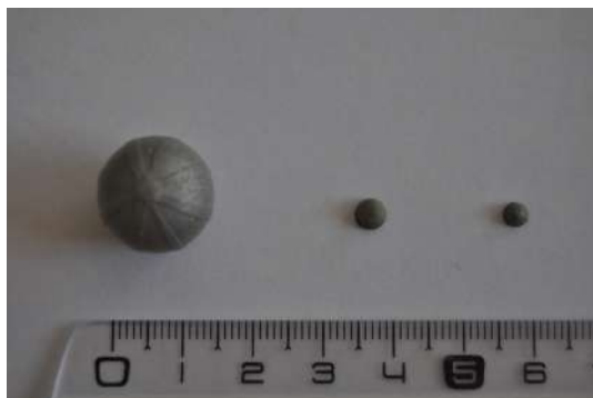
FIGURE 4.2 – Des marqueurs réfléchissants de différentes tailles. De gauche à droite : sphère de 14 mm de diamètre et demi-sphères de 4 mm et 3 mm de diamètre.
