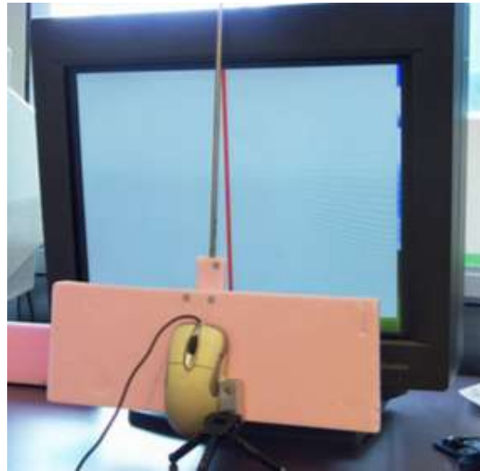
FIGURE 2.7 – Méthode de mesure de latence de Teather et al. [137]. La souris est fixe. La plaque de polystyrène entre l'écran et la souris effectue des mouvements pendulaires pendant la mesure. Les points gris sur la plaque sont les marqueurs réfléchifs suivis par le système Optitrack.
