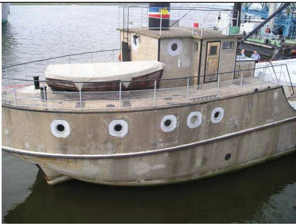
*Navire en béton léger datant de 1943 (Doc Argex)*
