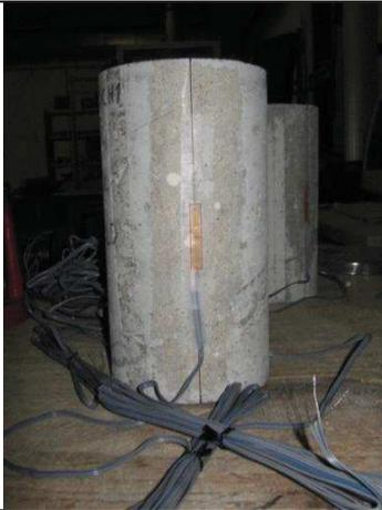
*Eprouvette équipée de jauges de déformation*
