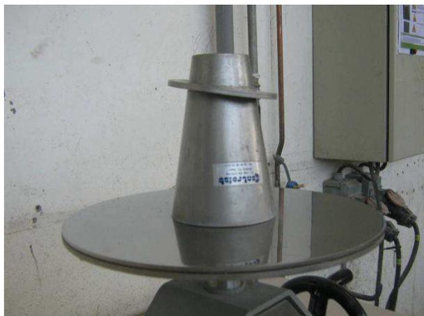
Figure 2.5 Mini cône
