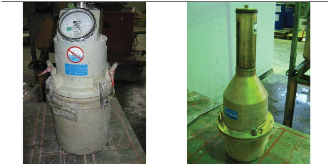
(a) Aéromètre à béton d'un volume de 8 litres (A)
