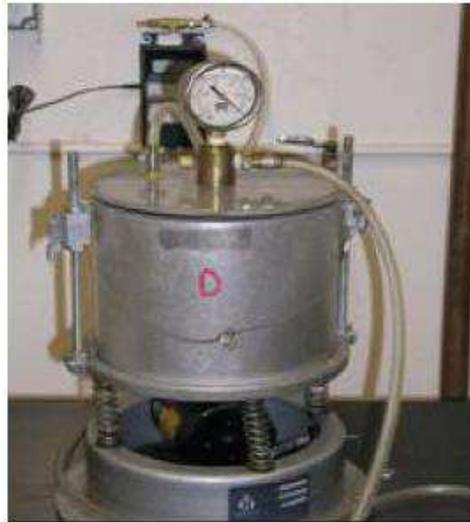
Figure 1.5 Appareillage de mesure de l'absorption d'eau sous vide (Mills-Beale et al. 2009)
