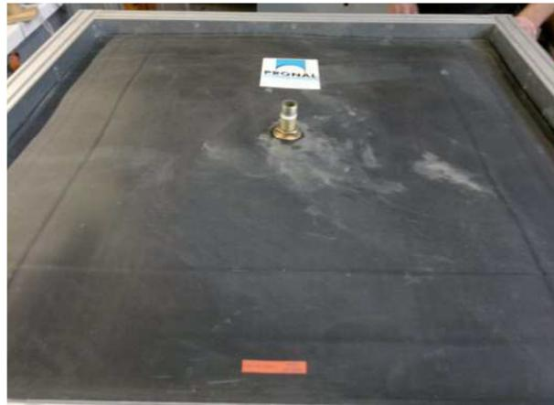
Figure 3.5 Membrane de chargement à pression d'eau contrôlée
