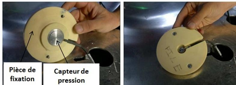
Figure 3.26 Capteur de pression dans la dalle et pièce de fixation
