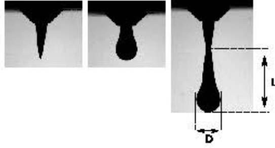
FIGURE 2.13 – Photo typique d'une goutte de métal liquide produite au niveau de la buse avec un diamètre de 2mm.
