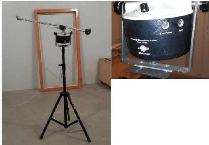
Figure 4. 12 : Bras rotatif Brüel et Kjaer, qui porte le microphone.
