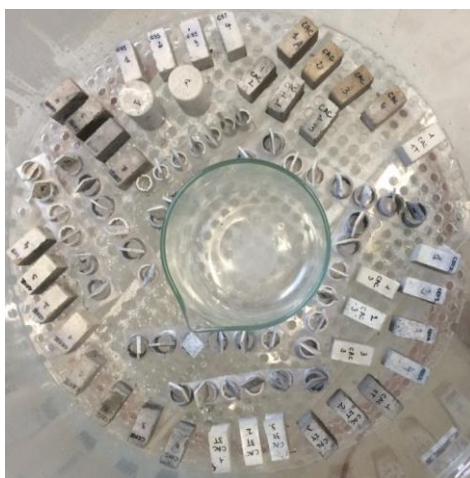
Figure 138 : Echantillons exposés à l'essai de biodétérioration final
