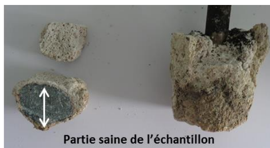
Figure 137: Mesure de la perte d'épaisseur pour un mortier à base de ciment CEM III, exposé 7 ans sur le site A (Tableau 41).
