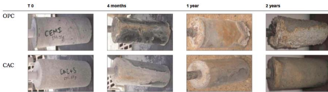
Figure 10 : Aspects visuels des échantillons exposés dans un réseau d'assainissement au cours du temps, extrait de Herisson et al. (2014).
