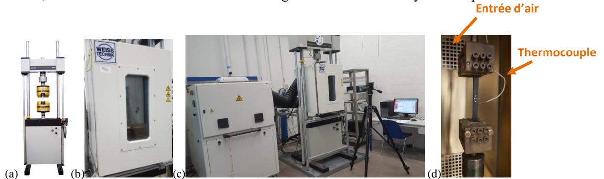
*Figure 3- 27 (a) groupe hydraulique INSTRON 8802, (b) Enceinte climatique WEISS, (c) Générateur thermique et station de travail du groupe hydraulique, (d) Entrée de flux d'air et position du thermocouple*
