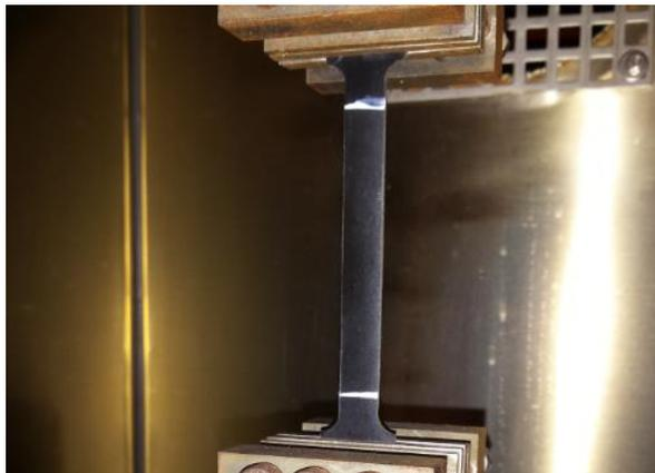
*Figure 6- 1 Montage de l'éprouvette entre les mors de l'INSTRON 8802*
