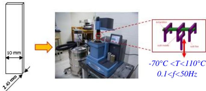
Figure 3- 23 Principe de l'essai d'analyse mécanique dynamique (DMA)
