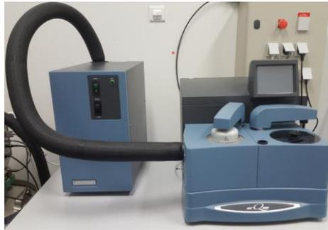
La capacité calorifique  $C_p$  du PA6 est obtenue par calorimétrie différentielle à balayage. Les informations fournies par l'industriel permettent de tracer l'évolution ci-dessous de  $C_p$  en fonction de la température.
