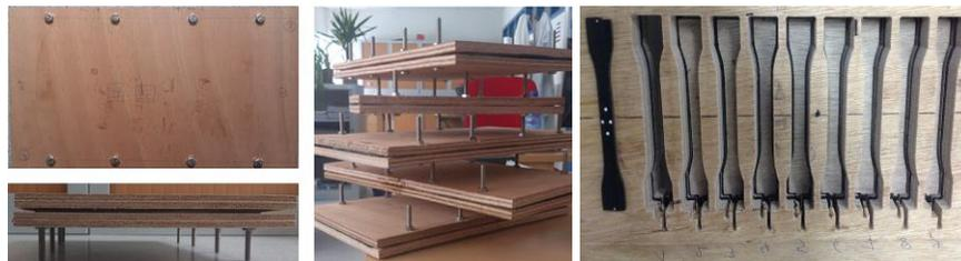
**Figure 3- 5 Fixation entre support de bois pour découpe au jet d'eau**
