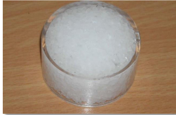
Figure I.15 : Photographie d'un scintillateur composite composé de cristaux de p-terphényle (crédit NCBJ)
