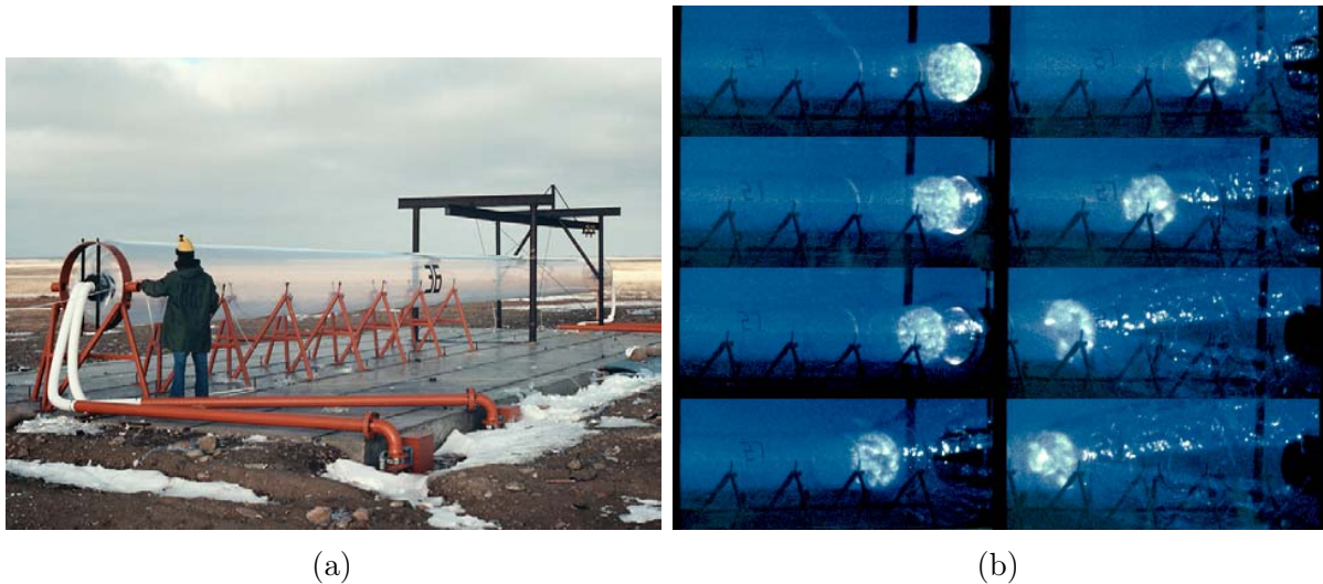
FIGURE 2.7 – Photographie du montage expérimental utilisé dans les travaux de Murray et Lee [86, 87] (a). Propagation d’une détonation dans un tube en plastique, 3.85% éthylène-air (b).
