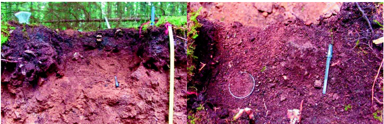
Figure II.3 : À gauche (vue de profil), réalisation d'une colonne verticale de prélèvement le long du profil d'altération situé sur le sommet du bassin versant du Strengbach. À droite (vue de dessus), prélèvement au cylindre d'un volume connu de sol permettant d'estimer la densité de la matrice fine des horizons.
