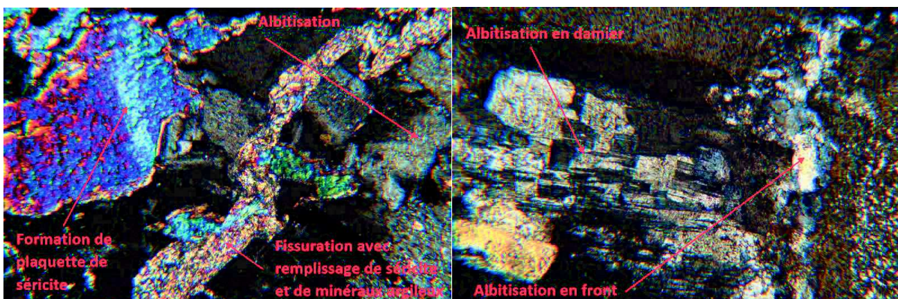
Figure A7 : à gauche, altération très forte d'un feldspath plagioclase (STR13-41B). À droite, zoom sur l'albitisation d'un feldspath plagioclase (STR13-41B).
