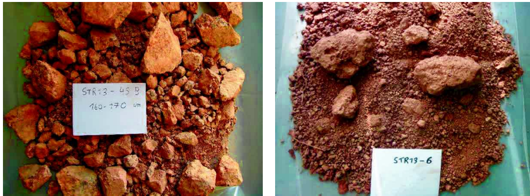
Figure II.4 : Aperçu de deux échantillons après séchage et avant le premier quartage. À gauche, un échantillon profond majoritairement constitué de blocs de granite (profondeur 160-170 cm). À droite, un échantillon de sol riche en matrice fine mais contenant quelques blocs de granite (profondeur 25-30 cm).
