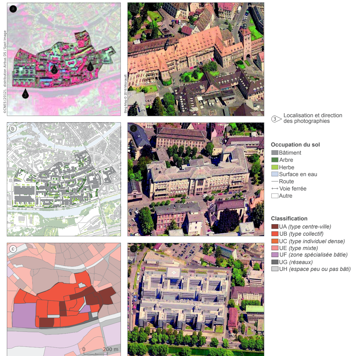
Figure 7.14 – Exemple de la difficulté d'évaluation de la morphologie urbaine par la base de données d'occupation du sol de la région Alsace : l'hôpital civil de Strasbourg représenté par l'image Pléiades (a), l'occupation du sol (b) et le résultat de la classification des mailles (c). Les photographies représentent des mailles classées en UA (1), UB (2) et UF (3)
