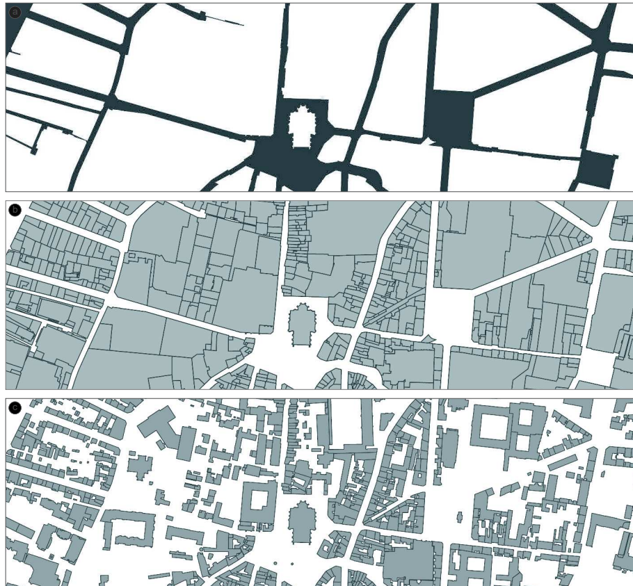
Figure 1.2 – Les trois éléments constitutifs des tissus urbains : les voies (a), le découpage foncier (b) et les bâtiments (c) (source : BD Parcellaire® – 2015) (d'après Panerai et al. , 1999)
