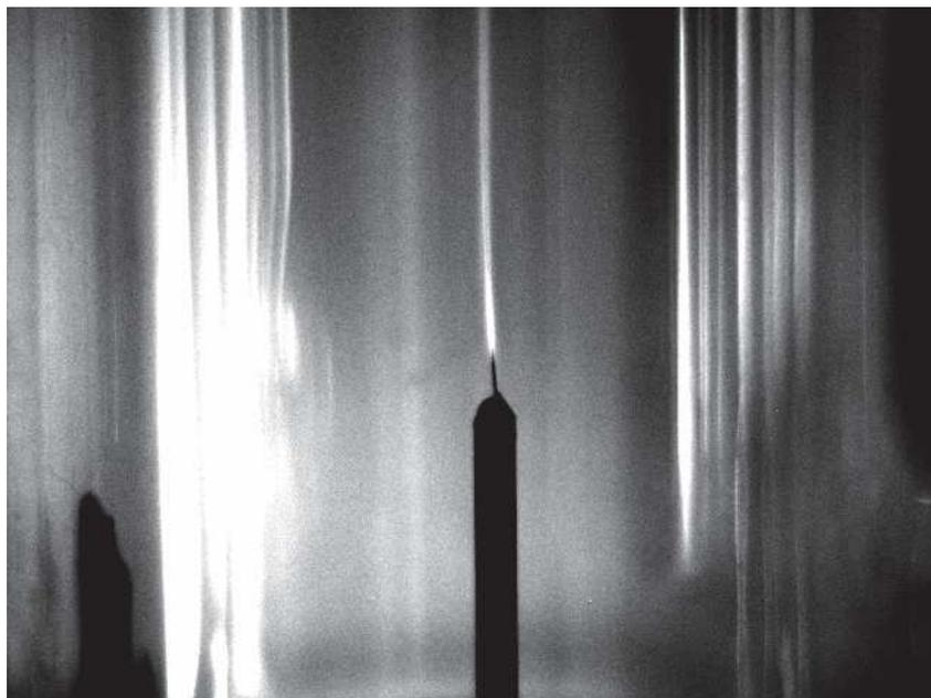
**Figure 4-7 : Un fil d'acier inox de 100  $\mu\text{m}$  porté à 10 kV dans un cylindre conducteur mis à la masse et rendu transparent grâce à un revêtement d'ITO. Le temps de pose est de 500 ms.**
