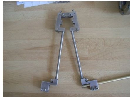
Figure 4.2 : Photos de l'expérience de dilatométrie, et détail de l'amplificateur de mouvement.
