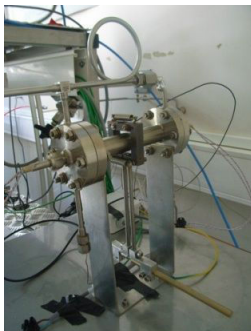
Figure 4.2 : Photos de l'expérience de dilatométrie, et détail de l'amplificateur de mouvement.
