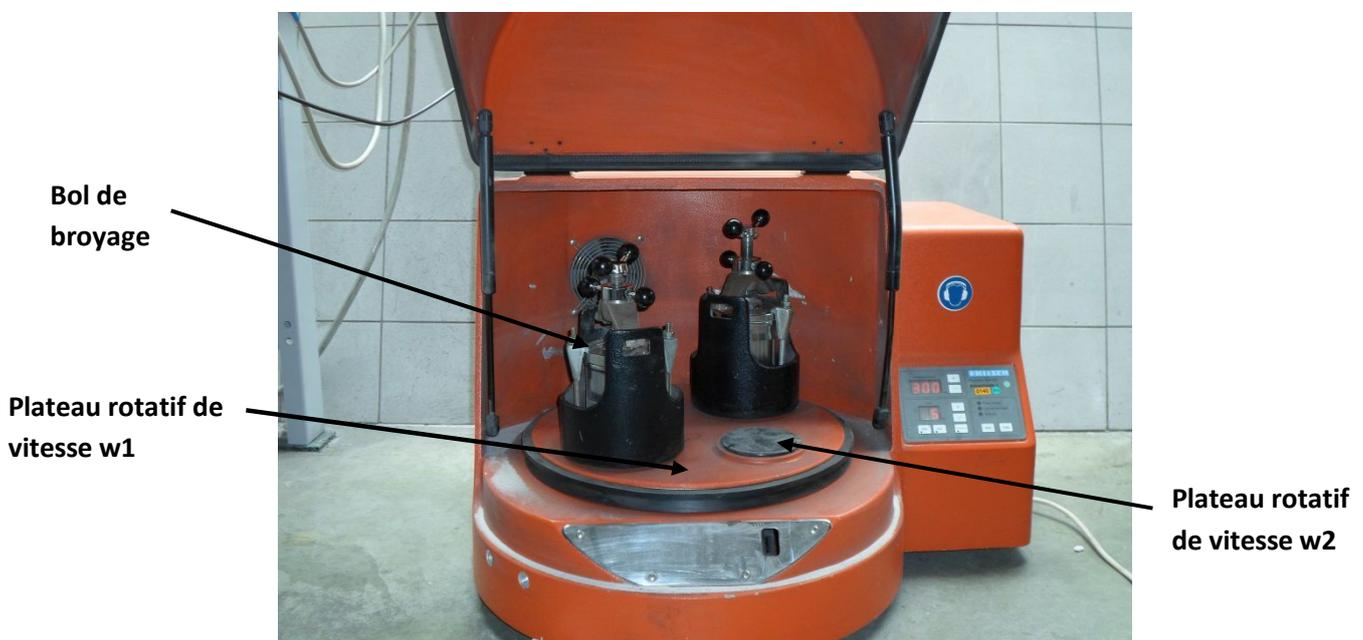
Figure 2.2 : Broyeur à billes de type planétaire.
