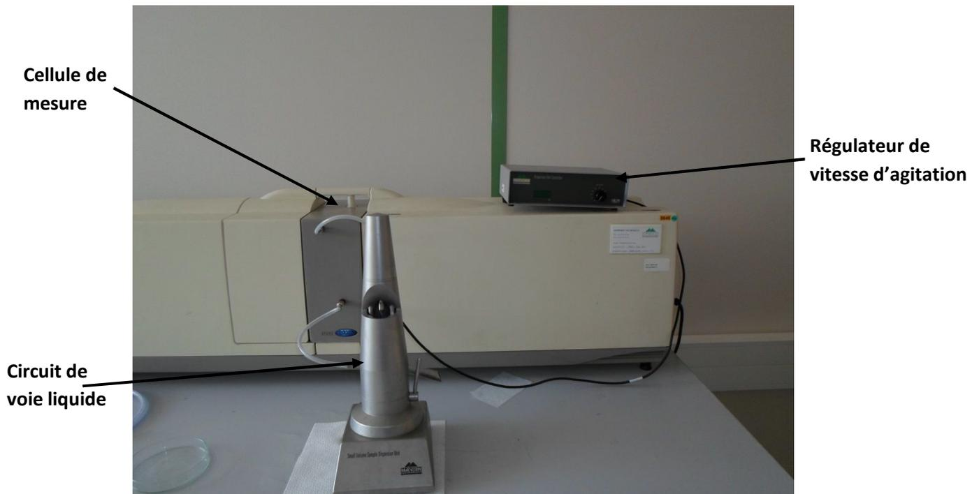
**Figure 2.7 :** Granulomètre Malvern Mastersizer 2000.
