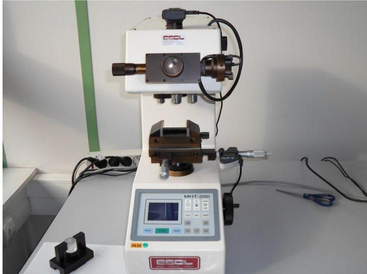
**Figure 2.11** : Micro-duromètre BRUCK.
