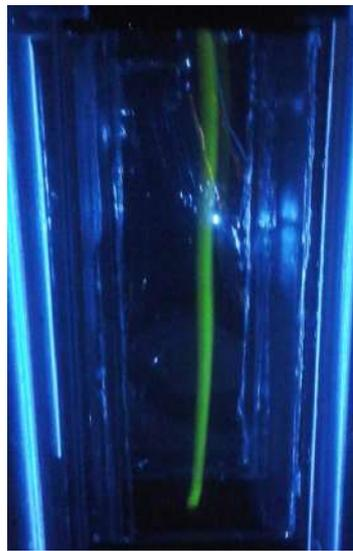
FIGURE 5.9 – Photo du panache de fluorescéine dans la cellule d'écoulement, pour un écoulement homogène (sans les billes). Le flux est dirigé du bas vers le haut.
