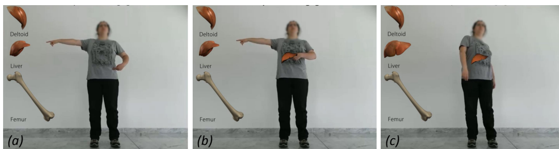
FIGURE 6.9 – Prototypage d'une interaction avec pointage pour le LBA. (a) Mauvais pointage du foie sur le corps. (b) Bon pointage du foie sur le corps, affichage de l'entité anatomique. (c) Mode miroir interactif.
