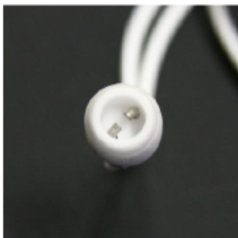
FIGURE 11.1 – Photographie de la cavité de l'actionneur JSP avec les deux électrodes.
