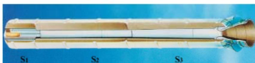
FIGURE 5.1 – Représentation schématique de la géométrie interne du P230. Chargement réparti en trois segments S1, S2 et S3.
