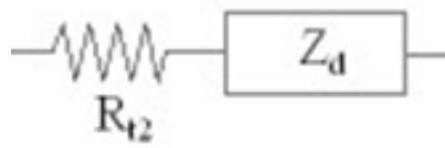
Figure F.2.1 1 : Schéma du circuit électrique équivalent modélisant l'impédance Z_2 intervenant dans l'impédance faradique.
