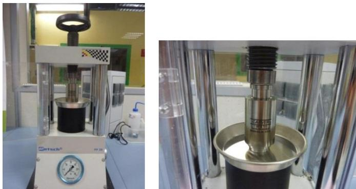
Figure 27 : Presse et module d'extraction utilisés pour l'extraction de la solution interstitielle des pâtes de ciment
