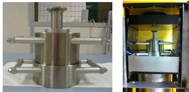
Figure E.2.1 : Presse et module d'extraction utilisés pour l'extraction de la solution interstitielle des mortiers.
