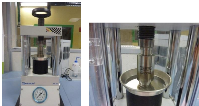
Figure 27 : Presse et module d'extraction utilisés pour l'extraction de la solution interstitielle des pâtes de ciment
