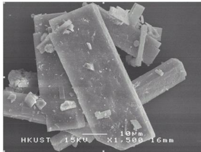
Figure 13 : Cristaux de \text{Mg}_2\text{KH}(\text{PO}_4)_2 \cdot 15\text{H}_2\text{O} observés au microscope électronique à balayage [43].
