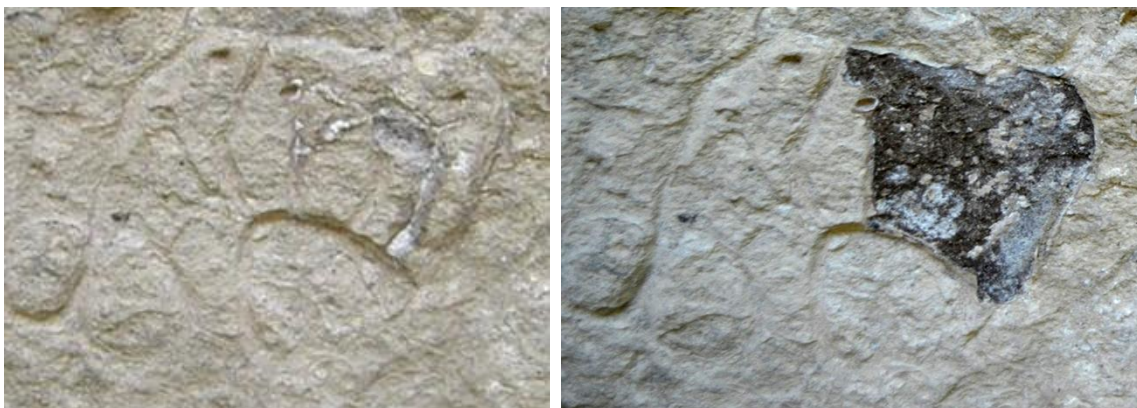
Figure 262 : Photographie de perte de matériel provoqué par une exfoliation de la paroi rocheuse constaté entre 2004 et 2013
