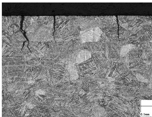
FIGURE 5.28 – Fissures secondaires sur une éprouvette de 2.25Mo après essai de traction lente ( 10^{-6} \text{ s}^{-1} ) en milieu NACE C
