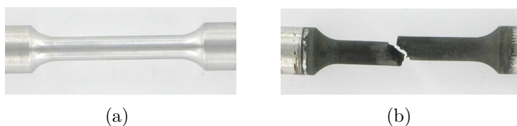
FIGURE 5.1 – Etat de surface des éprouvettes après essai de corrosion sous contrainte statique sur anneaux à 90% de la limite d'élasticité dans la solution NACE B à (a) pH=4,0, (b) pH=3,5
