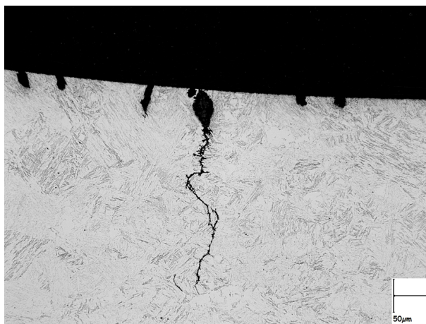
FIGURE 5.10 – Image MEB de la section transversale de la coulée 2.25Mo proche de la zone de rupture révélant des fissures secondaires après un essai en anneau dans la solution NACE B
