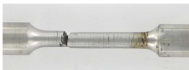
FIGURE 5.26 – Eprouvette de la coulée 2.25Mo après essai de traction lente ( 10^{-6} \text{ s}^{-1} ) dans la solution NACE C
