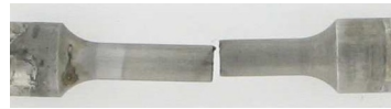
FIGURE 7.5 – Etat de surface des éprouvettes après essai de corrosion sous contrainte statique sur anneaux à 90% de la limite d’élasticité dans la solution NACE B
