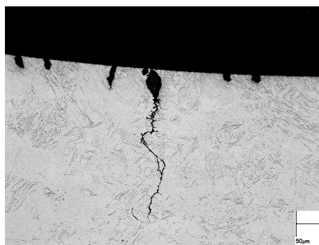
FIGURE 7.2 – Image MEB de la section transversale de la coulée 2.25Mo proche de la zone de rupture révélant des fissures secondaires après un essai en anneau dans la solution NACE B
