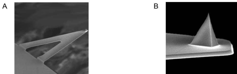
Figure 2.30 : (A) Image MEB du levier utilisé (B) Zoom sur la pointe du levier. Source : brukerafmprobes.com
