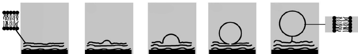
Figure 2.5 : Schéma du mécanisme de l'électroformation des GUV. D'après [Walde et al. 2010]
