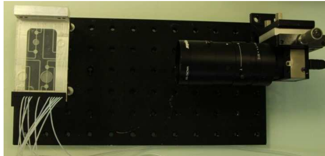
Figure I-13 : Photographie du banc de test avec la caméra positionnée pour filmer le profil de la carte microfluidique.
