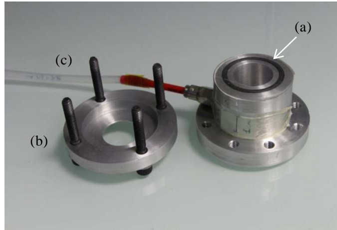
Figure I-5 : Photo de l'enceinte de test de soufflage. La membrane est placée au-dessus du joint (a) puis l'anneau de maintien (b) est vissé au support. La connexion (c) est reliée au générateur de pression.
