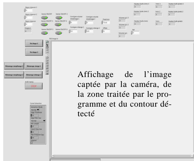
Figure V-2 : Capture d’écran du programme de contrôle de la carte de dilution programmable. A partir de cette interface il est possible de piloter toutes les vannes de la carte manuellement, de calculer les volumes des trois réservoirs à partir des images de la caméra et de contrôler le remplissage et la vidange des réservoirs A et B de manière automatique.
