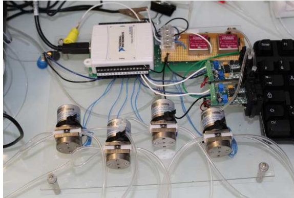
Figure I-12 : Photo des électrovannes et de la carte d'acquisition NI USB6009.
