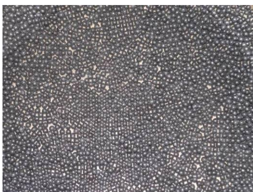
Figure 212 – Lot de billes de plomb utilisé pour la compression latérale en cellule cubique
