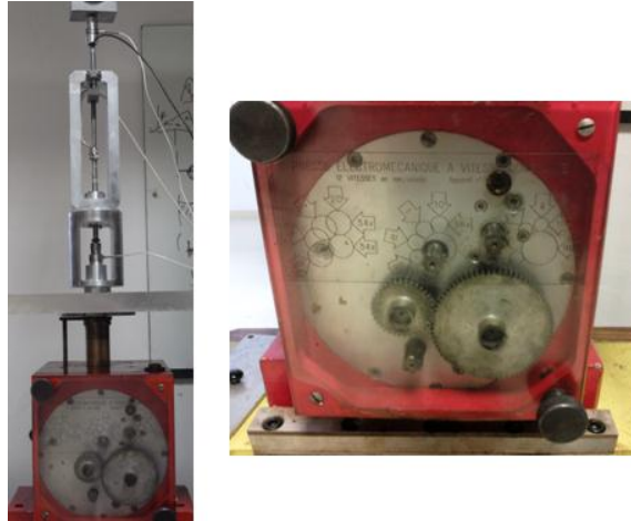
Figure 69 : Montage MATHRYX sur une presse mécanique 2 tonnes
