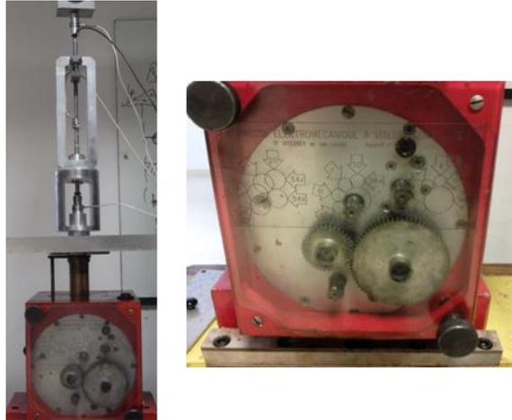
Figure 69 : Montage MATHRYX sur une presse mécanique 2 tonnes
