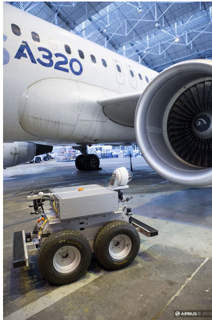
Figure 6.1: Air-Cobot en train d'inspecter un A320.
